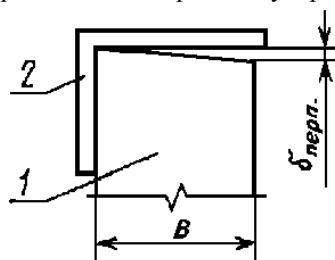
1 - панель; 2 - поверочный угольник  $90^\circ$ ; В - ширина панели
