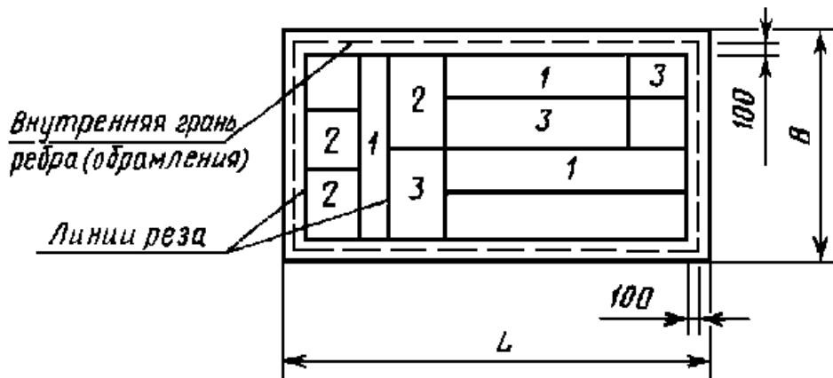
Места вырезки образцов: 1 - для проверки плотности (объемной массы), прочности при растяжении, сжатии и сдвиге, прочности сцепления с листами при равномерном отрыве и сдвиге, модуля упругости и модуля сдвига пенопласта; 2 - для определения коэффициента теплопроводности пенопласта; 3 - для определения влагопоглощения и водопоглощения пенопласта; L - длина панели; B - ширина панели.
