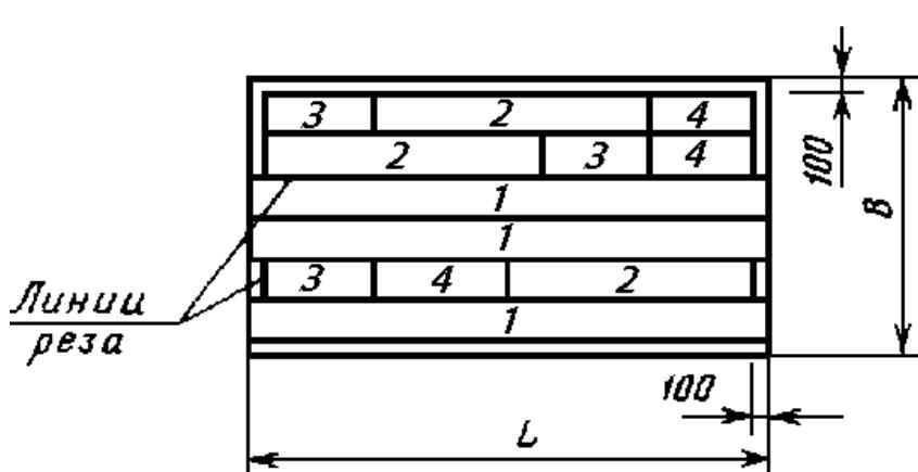
Места вырезки образцов: 1 - для проверки прочности и жесткости панелей при поперечном изгибе; 2 - для проверки плотности (объемной массы), прочности при растяжении, сжатии и сдвиге, прочности сцепления с листами при равномерном отрыве и сдвиге, модуля упругости при растяжении и модуля сдвига пенопласта; 3 - для определения коэффициента теплопроводности пенопласта; 4 - для определения влагопоглощения и водопоглощения пенопласта; L - длина панели; B - ширина панели.
