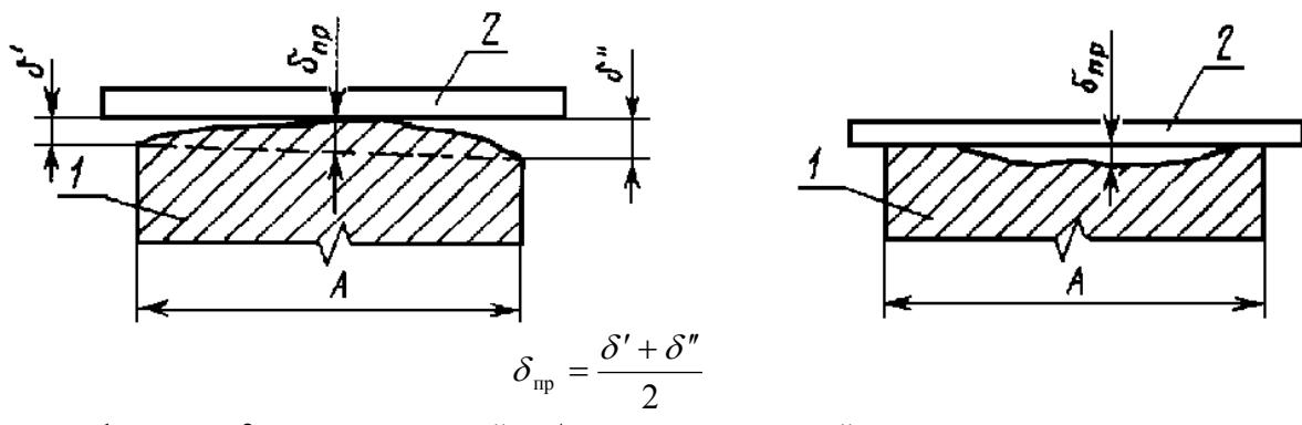
Длина поверочной линейки или рейки должна быть не менее длины проверяемой панели.
